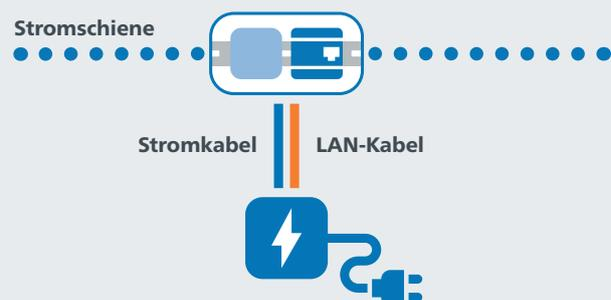
Abb. 2: Vom MultiNode LAN im Abgangskasten bis zur Wallbox wird ein kurzes LAN-Kabel gelegt.
