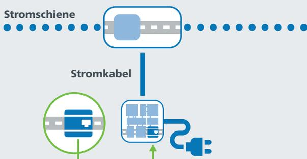
Abb. 1: Das MultiNode LAN-Gerät ist in der Ladestation verbaut und wird dort mit der Kommunikationsschnittstelle verbunden.
